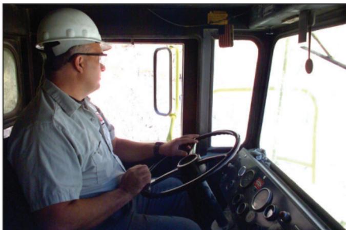
Después de que la máquina se haya precalentado, opere el Volante con la máquina parqueada o a baja velocidad, para determinar si el Volante responde. Sí hay algunas partes sueltas, apretadas, ruidos inusuales, o el sistema del Volante está duro, este debe ser chequeado por una persona autorizada.
